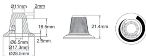
Para eje de diámetro de 6,35 mm, PPS negro, media luna blanca. Temperatura máxima de la perilla 200°C/392°F
